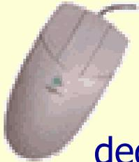
**Mouse:** è stato introdotto con i sistemi operativi dotati di interfaccia grafica; si collega al PC attraverso una porta ad esso dedicata, PS/2 e oggi anche USB, o una porta seriale COM1/COM2.
