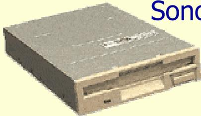
Sono dispositivi in cui si inserisce il floppy disk o in cui collocare il CD o il DVD o qualsiasi altro tipo di disco. I drive hanno una o più testine di lettura/scrittura con cui avviene il trasferimento dei dati (i bit) fra disco e memoria centrale.
