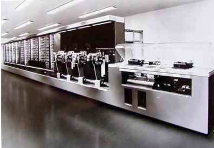
Fig. 19 - Il MARK I è un computer elettromeccanico: le sue operazioni di base sono svolte da parti meccaniche controllate elettricamente da circa 3'000 relay.
