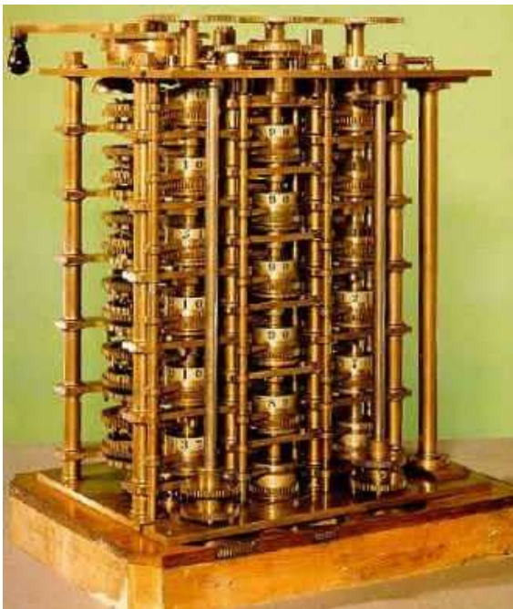
Fig. 12 – Ricostruzione del Differential Engine
